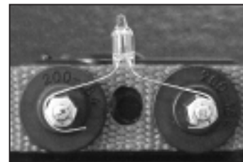
Installation de la lampe témoin sur les palpeurs
